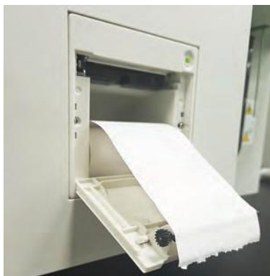
Figura 2-9 Instalação do papel térmico (2)
