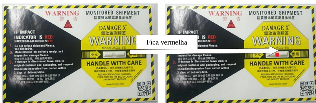
Figura 3-5 A etiqueta à prova de choque fica vermelha
