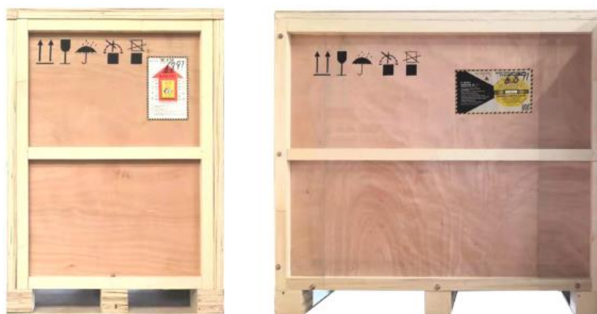
Figura 3-4 Posição da etiqueta anti-inclinação Figura 3-4 Posição da etiqueta à prova de choque
