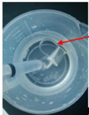
Figura 3-33 Verificando se a câmara de isolamento é ou não hermética
