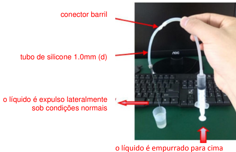
A Figura 3-37 Verificar o líquido de empurrando a sonda de amostragem
