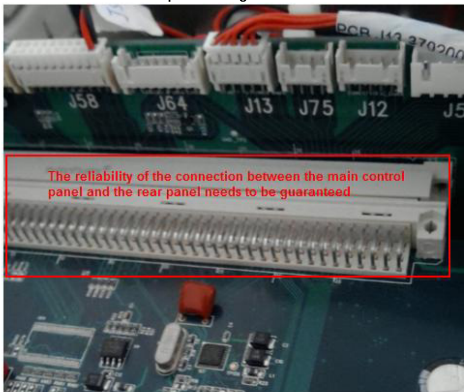
Figura 4-8 A confiabilidade da conexão entre o painel de controle principal e o painel traseiro precisa ser garantida
