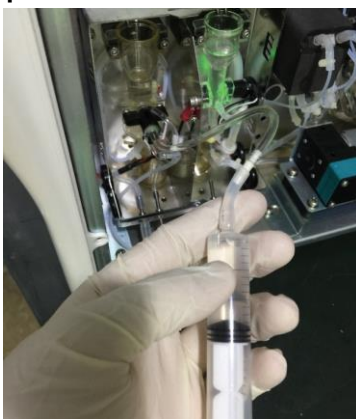
Figura 2-28 Limpeza da abertura do banho do RBC
