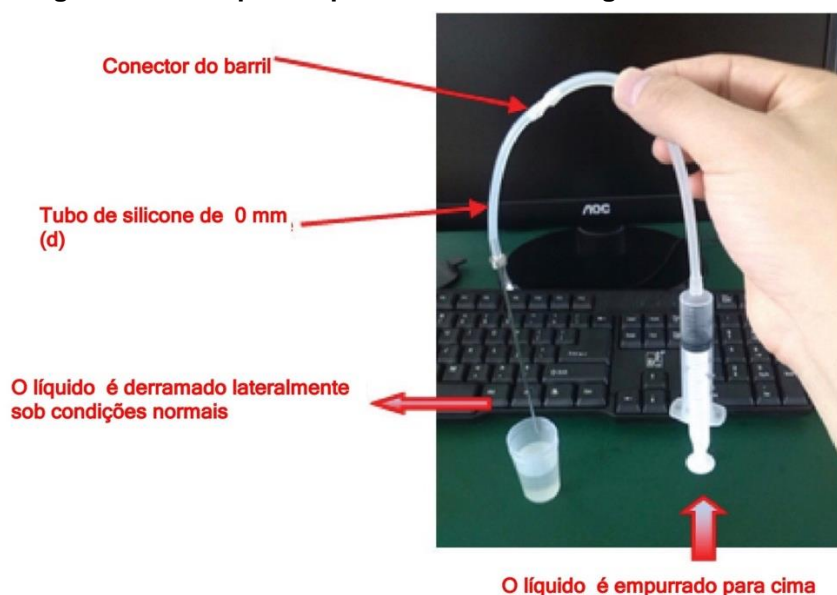
Figura 2-33 Cheque o líquido emburrando a agulha de amostra
