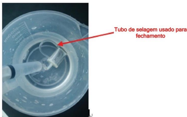
Figura 2-30 Verificando se a câmara de isolamento é hermética ou não
