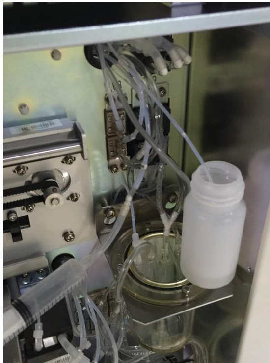
Figura 2-27 Limpeza da câmara de fluxo/DIFF
