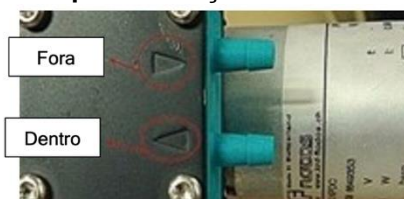
Figura 2-26 Símbolos para a direção do fluxo de entrada e saída
