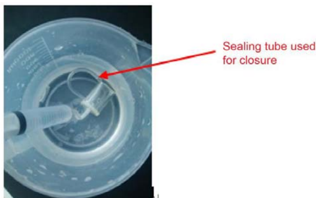
Figura 2-27 Verificando se a câmara de isolamento é ou não hermética
