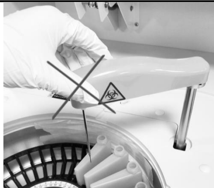
Figura13-4 Operação errada do braço giratório
