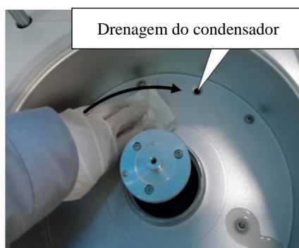
Figura 13-18 Limpando o condensador
