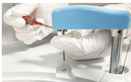
Figura 13-33 Solte os parafusos
