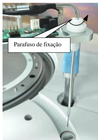
Figura 13-23 Removendo a sonda
