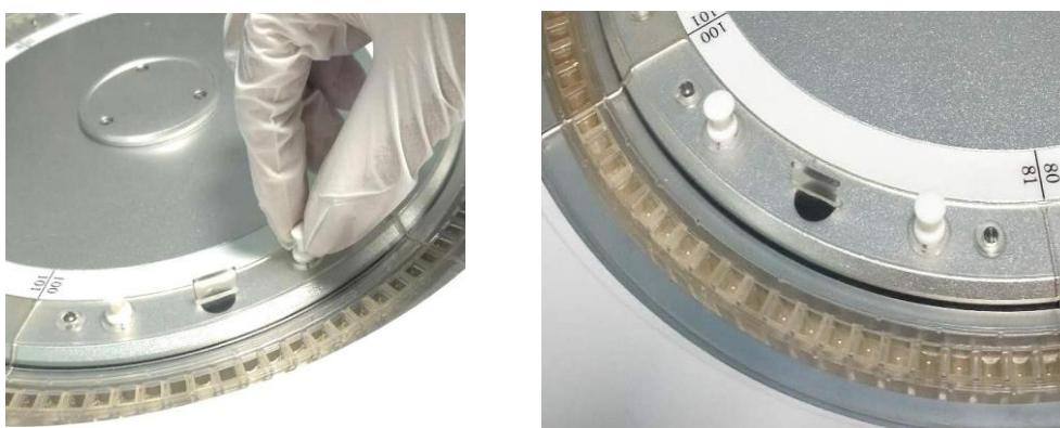
Figura 13-7 Desaparafuse o parafuso de fixação
