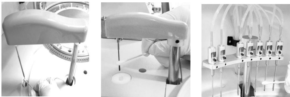
Figura 13-5 Limpando a parede externa da sonda
