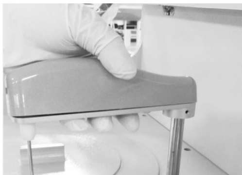
Figura 13-19 Removendo a tampa da sonda
