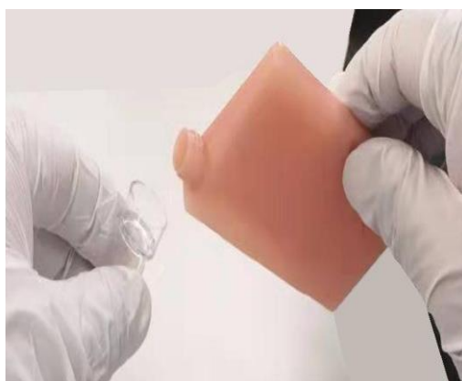
Figura 13-46 Adicionando fluido de limpeza na posição da amostra
