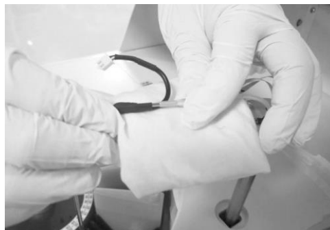
Figura 13-22 Desconectando a tubulação
