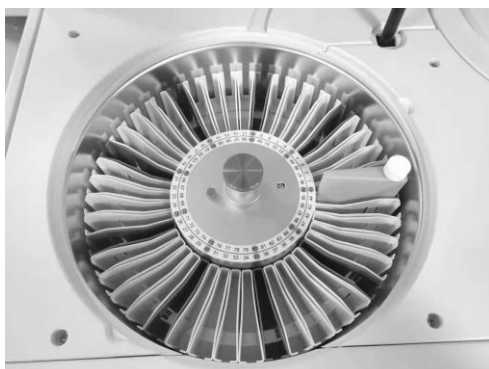
Figura 13-45 Adicionando fluido de limpeza na posição do reagente
